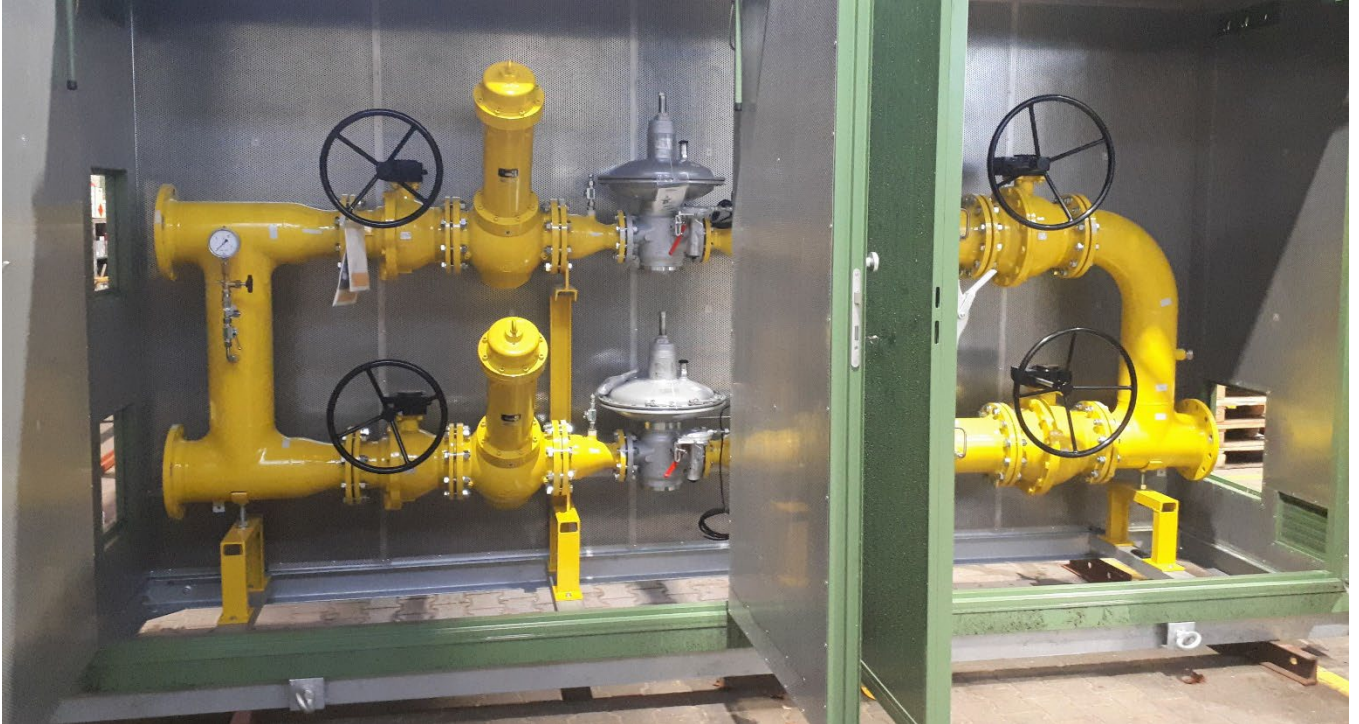
Prête au transport chez le client : le régulateur de pression de gaz conçue par SPIE tient dans une armoire en aluminium. Droits d'auteur : SPIE
