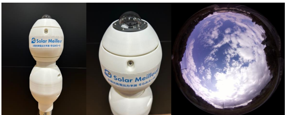
Dispositif appelé "Solar TAMAGO" et image intégrale du ciel
